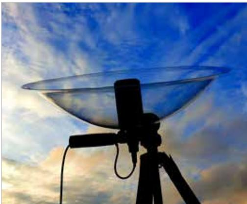
*Parabolmikrofon am Einsatzort, Foto: C. Groß*
